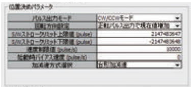
〔定位功能的参数设定示例〕 脉冲输出模式：CW/CCW模式 旋转方向设定：正转脉冲输出时，当前值增加
